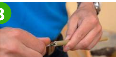
Mit den Bohrern eventuell vorhandene Tülle aus Bambusstangen entfernen
