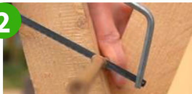
Bambus in kleine Segmente sägen, so dass diese etwas länger als die Dose sind
